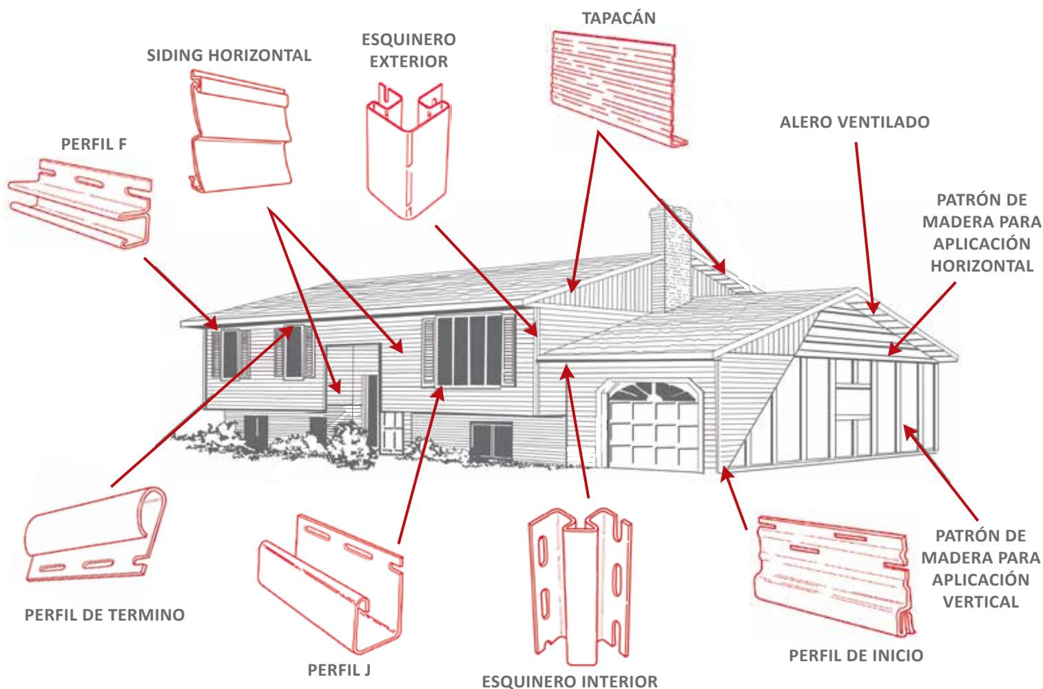
TODAS LAS CASAS SE PUEDEN DIVIDIR EN FORMAS DE RECTÁNGULOS O TRIANGULOS O UNA COMBINACIÓN DE AMBOS. EL ÁREA A SER RECUBIERTA PUEDE DETERMINARSE MIDRIENDO LA ALTURA Y EL ANCHO DE LA CASA, INCLUIDAS LAS VENTANAS. LAS VENTANAS Y LAS PUERTAS NO SE SUELEN RESTAR PARA SACAR EL AREA DE LO QUE VA A COMPRARSE EN SIDING.
