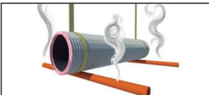
3.- NO LO INSTALE CERCA DE SUPERFICIES CALIENTES (CALDERAS, TUBOS DE VAPOR, CALENTADORES, BALASTROS, ETC).
