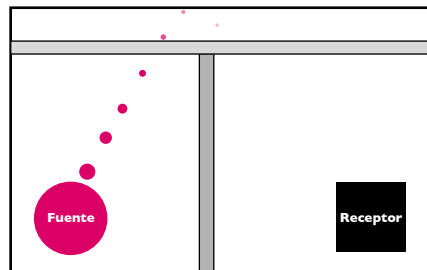
Figura 11: Los techos acústicos ayudan a atenuar la transmisión de sonido entre habitaciones.
